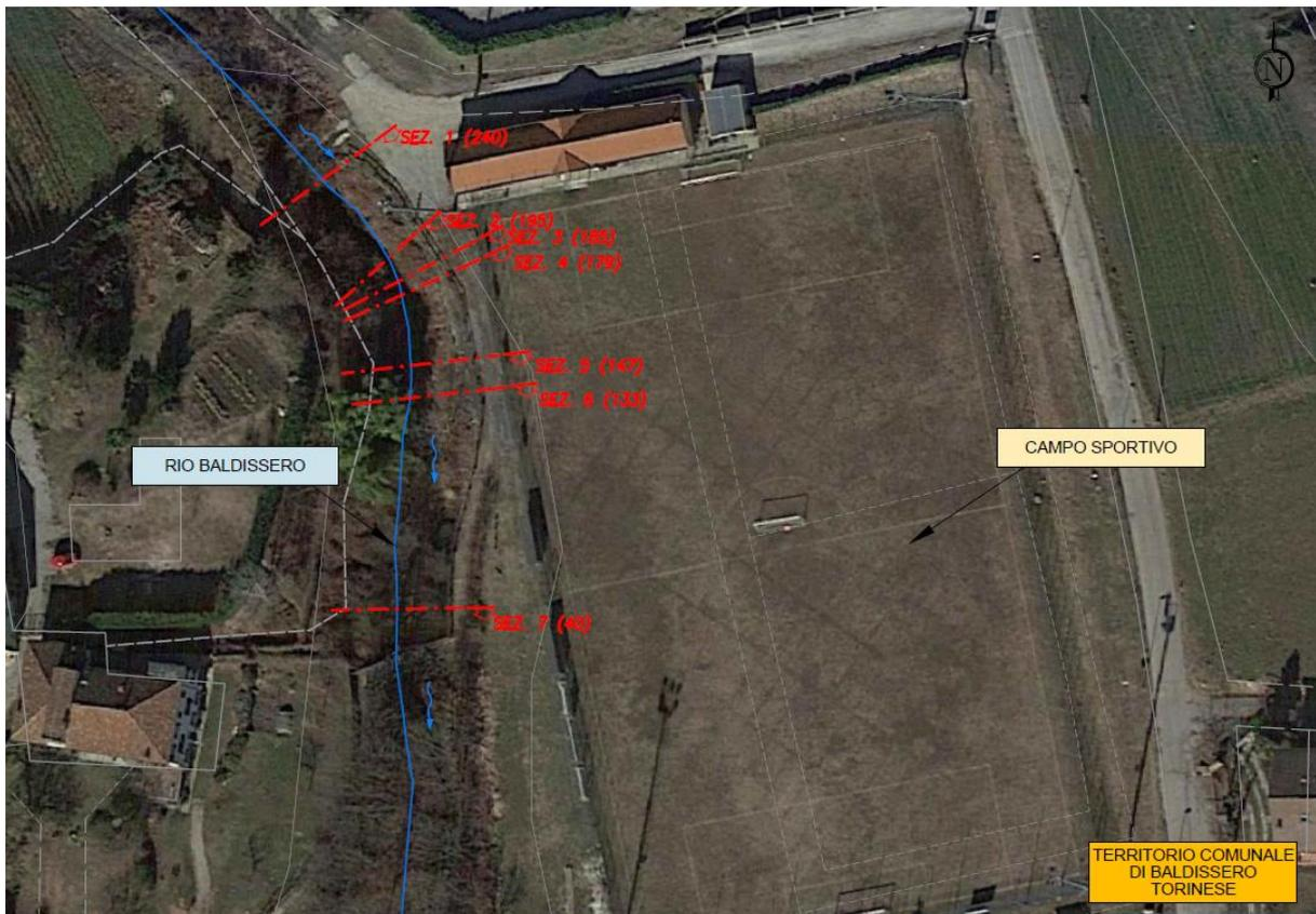
**Figura 6 - Ubicazione sezioni di rilievo, utilizzate per l’allestimento del modello idraulico lungo il tratto di intervento Rio Baldissero - Campo Sportivo.**
