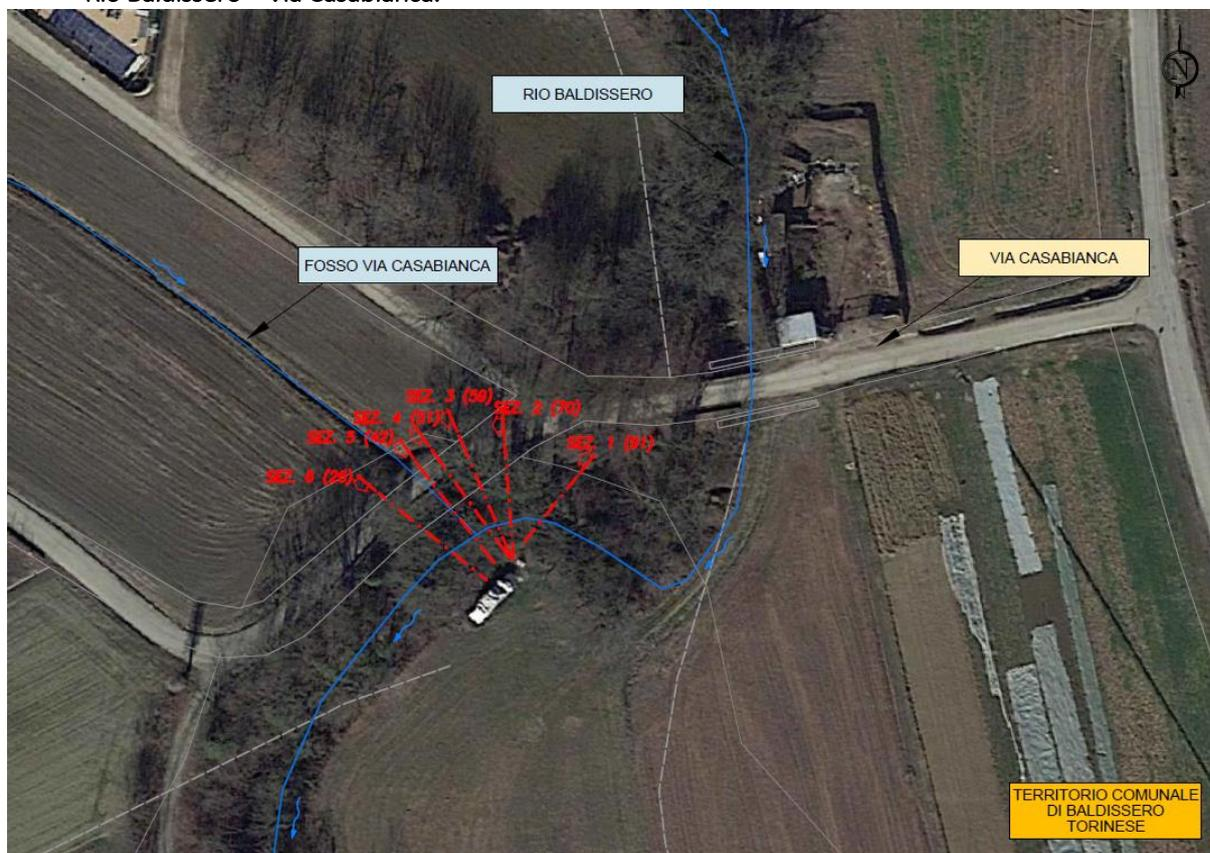
**Figura 7 – Ubicazione sezioni di rilievo, utilizzate per l’allestimento del modello idraulico lungo il tratto di intervento Rio Baldissero – Via Casabianca.**
